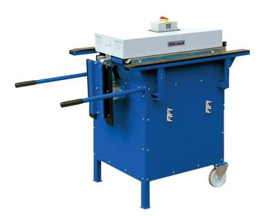
Die Profiliermaschine EPM-25 dient zur Herstellung von Doppelstehfalzprofil 25, aus Zuschnitten oder von Tafelmaterial, in zwei Durchläufen. Sie ist als universelle Maschine für den Einsteiger oder als Zweitmaschine für Arbeiten auf der Baustelle konzipiert.
